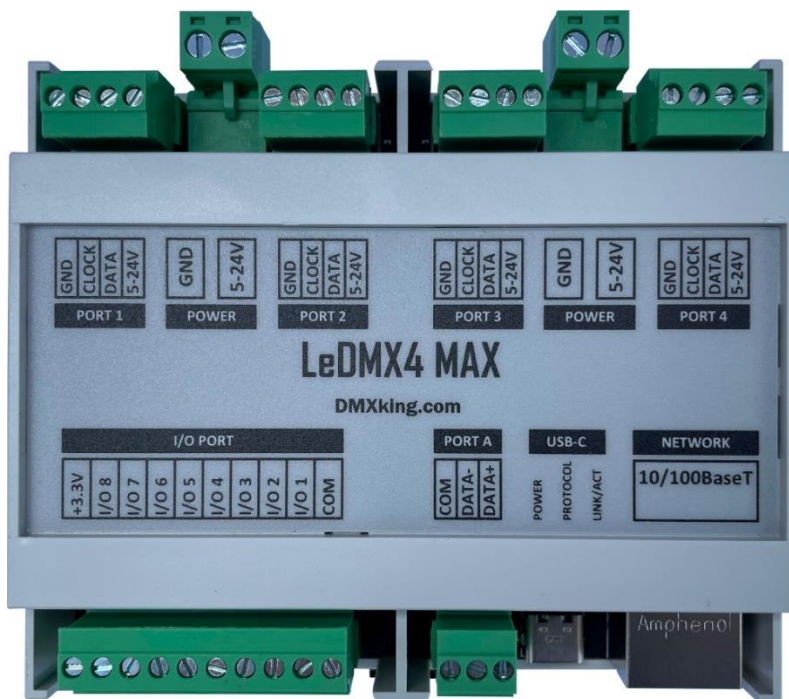
LeDMX4 MAX I/O Port 8x trigger inputs
