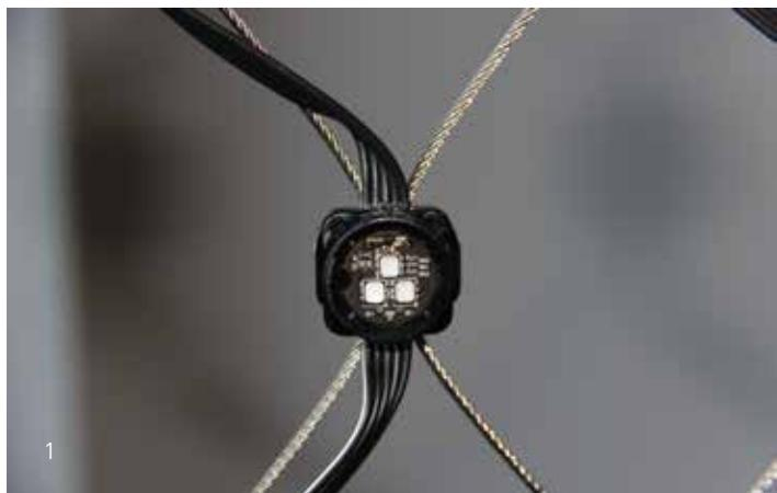
X-LED LINE LED-Ketten werden mittels Edelstahlklammern auf einem Edelstahlseilnetz befestigt. Die Maschenweite bzw. der Pixelabstand ist zwischen 50 und 300 Millimetern frei wählbar. Das Netz wird umseitig an einer Trägerstruktur angeschlossen. Die Größe der LED-Netze ist hierbei ebenfalls frei wählbar und kann individuell an die Gebäudegeometrie angepasst werden.
